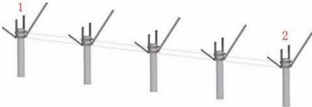
图 4.2 抱箍撑杆定位示意图
