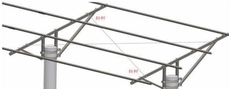
图 4.4 防风拉杆安装示意图
